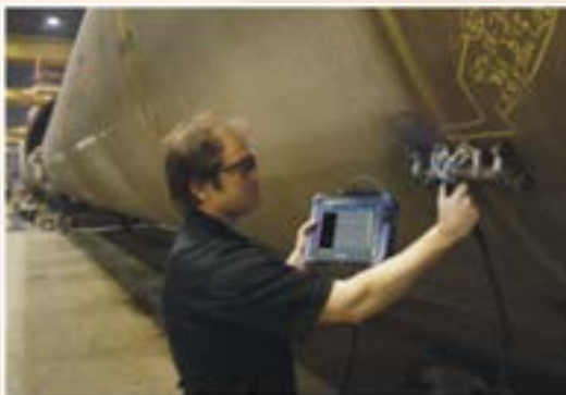
TOFD Weld Inspection
